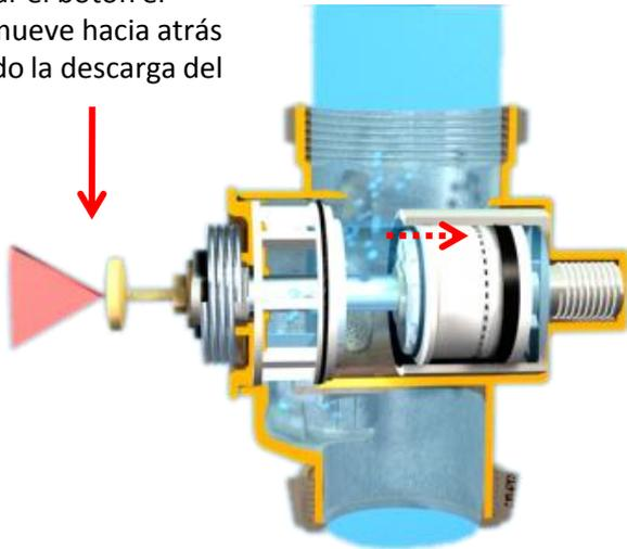
Luego de 6 segundos el pistón vuelve a su posición original para cortar el paso de agua.
