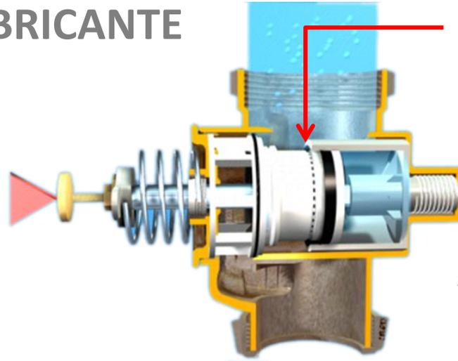
Cuando la válvula no es activada el pistón impide la descarga del agua.
